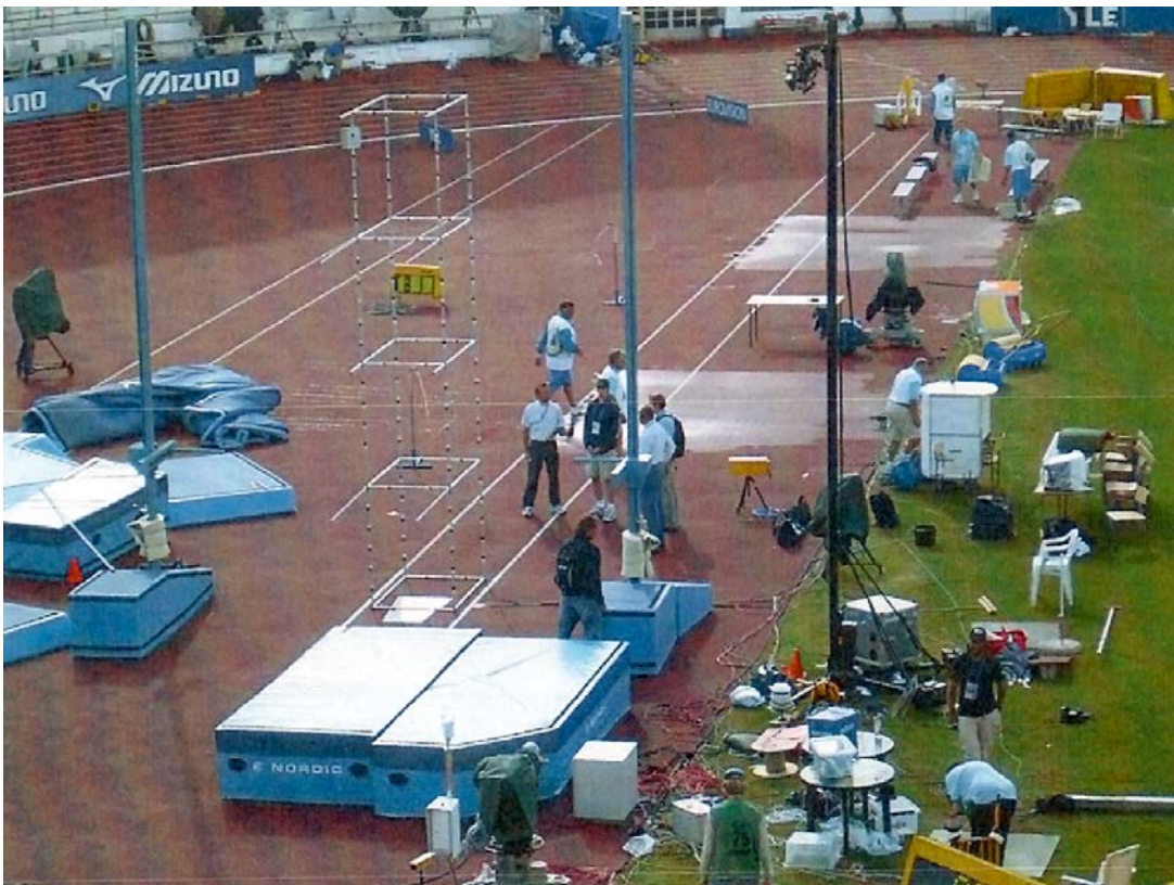
Abb. 4.17 Messkörper im Stabhochsprung zur Justierung der Kameras
