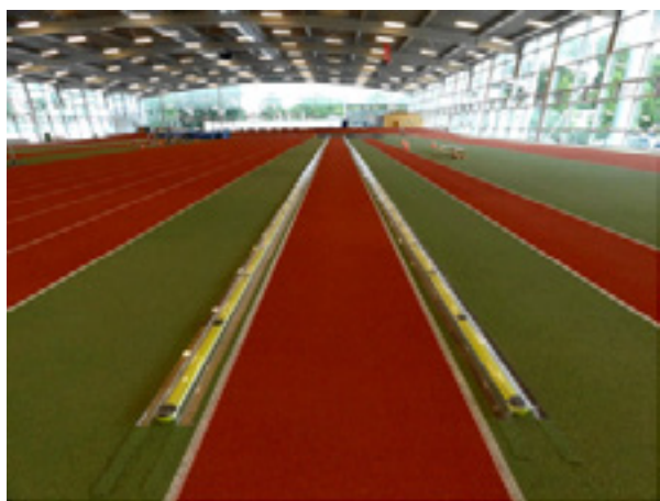
Abb. 1. OptojumpNext Messgerät mit einer Länge von 50 m
