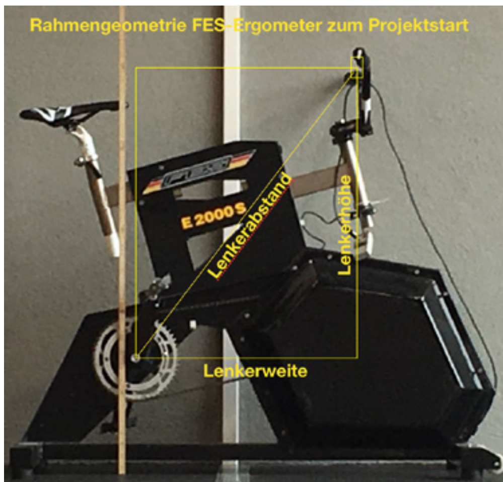
Abb. 1: Rahmengenometrie des FES Ergometers zum Projektstart
