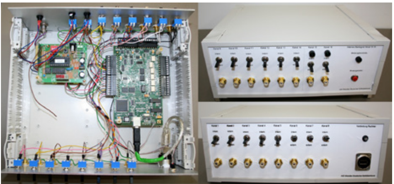
Abb. 2: Vollständig neu entwickelte skalierbare Datenbox mit 16-Kanal A/D-Wandler-Einheit, 8-Kanal Funkschaltssystem, Cinch-Buchsen & USB-Typ A Anschluss
