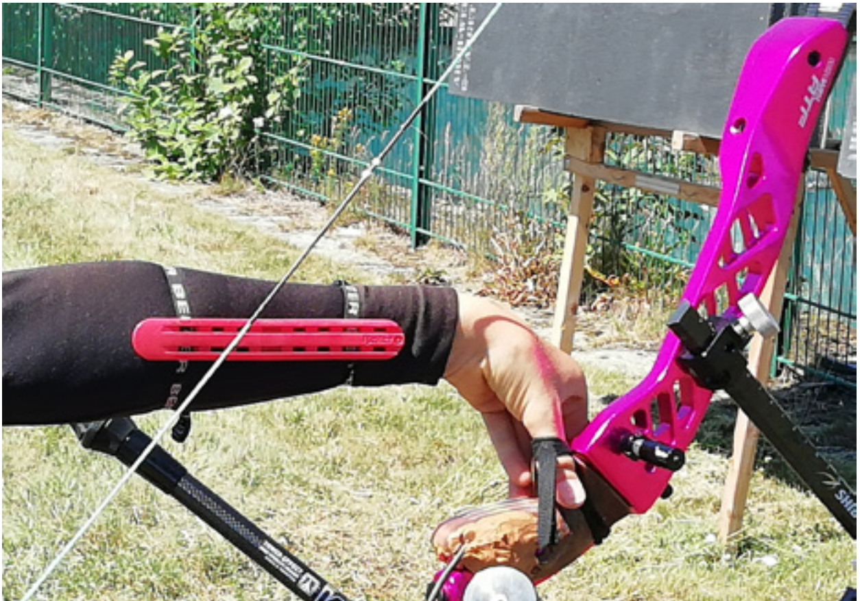
Abb. 4b: Feldmessung mit dem neu entwickelten Messsystem am OSP Berlin. Instrumentiertes Griffstück montiert am Bogen der Athletin.
