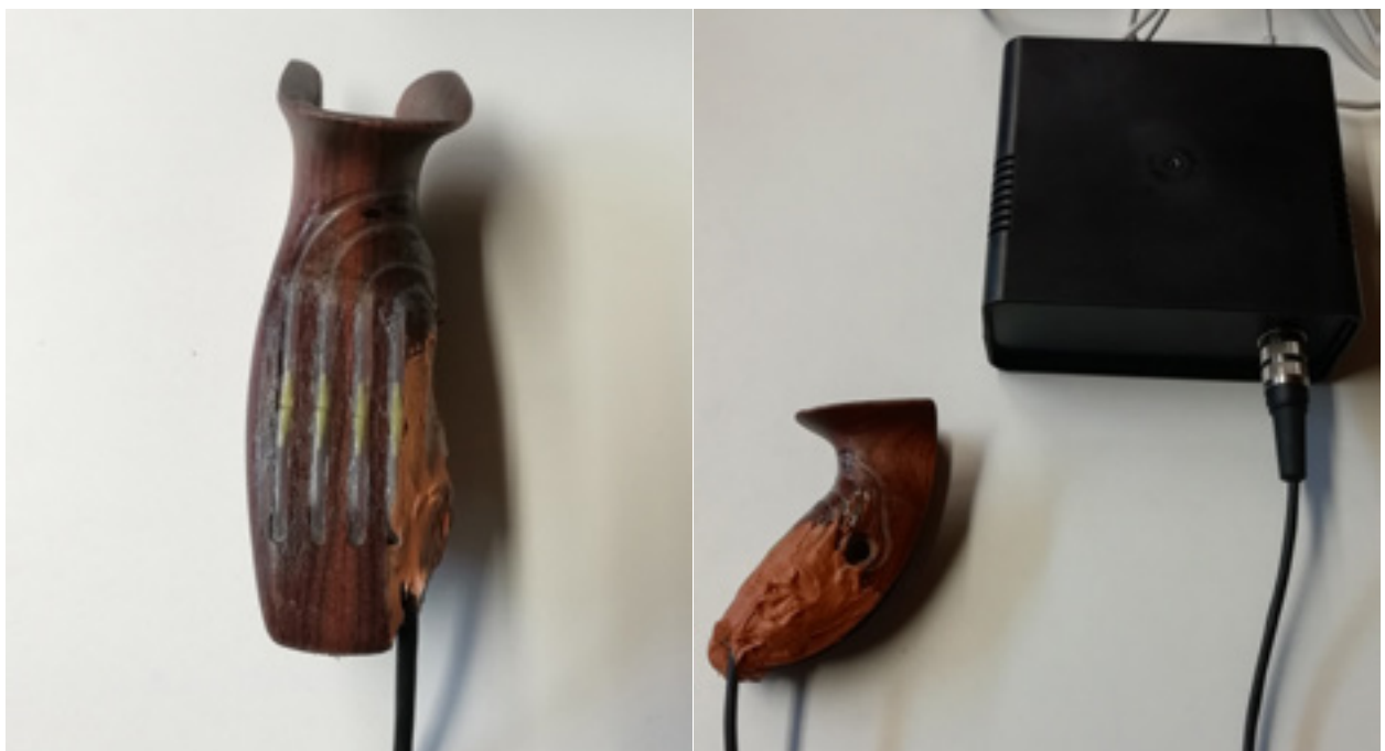
Abb. 2: Prototyp des am IfSS gefertigten Griffstücks mit acht in den Bogengriff eingearbeiteten Sensoren sowie dem kabelgebundenen Anschluss an den A/D-Wandler.
