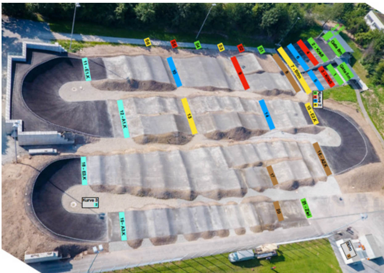
Abb. 4: Darstellung der eingebauten Messschleifen der Zeitmessanlage von MOTO Sheets
