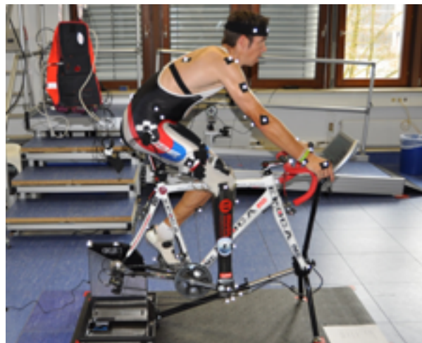
Abb.1: Ergometermessplatz mit Cyclus 2 Ergometer, 3 D Kinematik, SRM und Pedalkraftmessung
