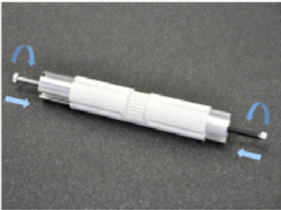
Abb. 7: Funktionsmuster der Testprothese RATE-PRO. Die Längeneinstellung der Prothese kann über einen Spannschloss-Mechanismus mit Drehrad schnell und zuverlässig eingestellt werden. Der Vorfuß-Hebel kann durch ein Hirth-Gelenk (Grobeinstellung) und eine Gelenkschiene am proximalen Prothesenende (Feineinstellung) ebenfalls ohne die Verwendung von Werkzeug eingestellt werden. Die Anschlüsse an Prothesenschaft bzw. Pedalplatte erfolgen über standardisierte Prothesenteile und normierte Bohrungen. Das hier dargestellte Funktionsmuster wurde final überarbeitet (Materialverstärkungen, Belastungssimulation mit Ansys, Werkstoff-Auswahl für 3D-Druckteile) und steht seit April 2016 für Probandentests zur Verfügung.
