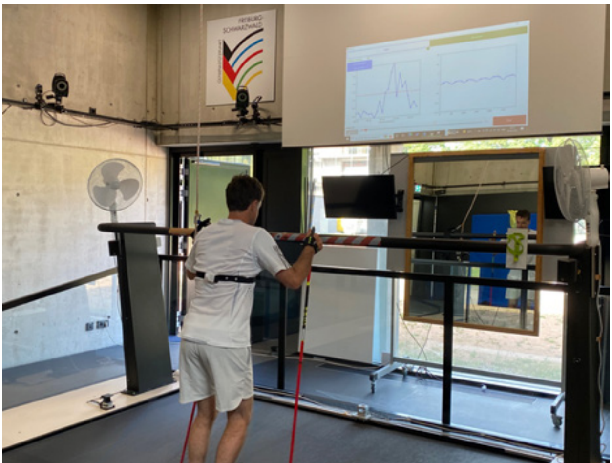
Abb. 3: Testdurchlauf im Ski-Langlauf mit Befestigung eines Sensors an der Brustwirbelsäule zur Betrachtung der Oberkörperbewegung
