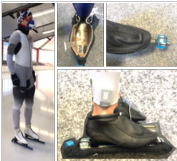
Abb. 1: Mit mobiler Messtechnik instrumentierter Sportler. Die Druckmesssohle wurde direkt in die Schlittschuhe eingelegt und mit Datenloggern verbunden, die am Knöchel befestigt waren. Je nach Protokoll wurden zusätzliche Datenlogger an den Kufen angebracht.
