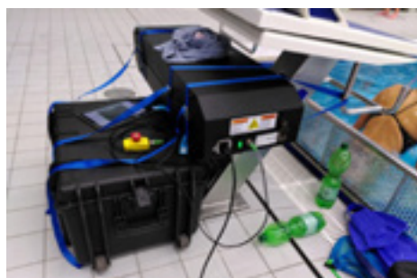
Abb. 1: Anbringung des Zugwiderstandssystems „1080 Sprint“ hinter dem Startblock
