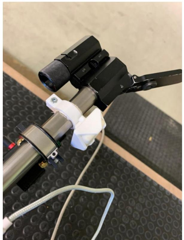
Abb. 3: NilsPod Sensor befestigt am Gewehrlauf mittels 3D-gedruckter Halterung
