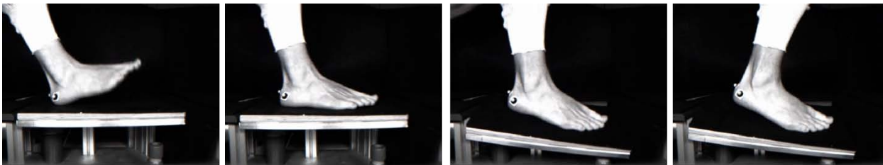
Abb. 1: Klappmechanismus der Plattform während des Gehens
