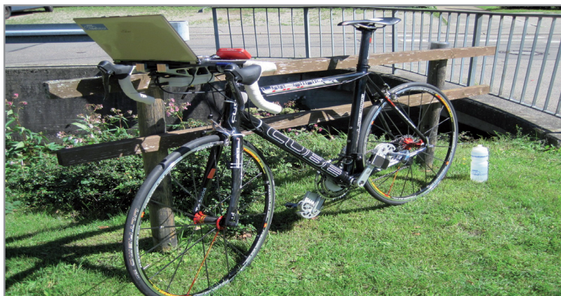
Abb.2. Das Messrad mit Netbook und Powerforce Messsystem.
