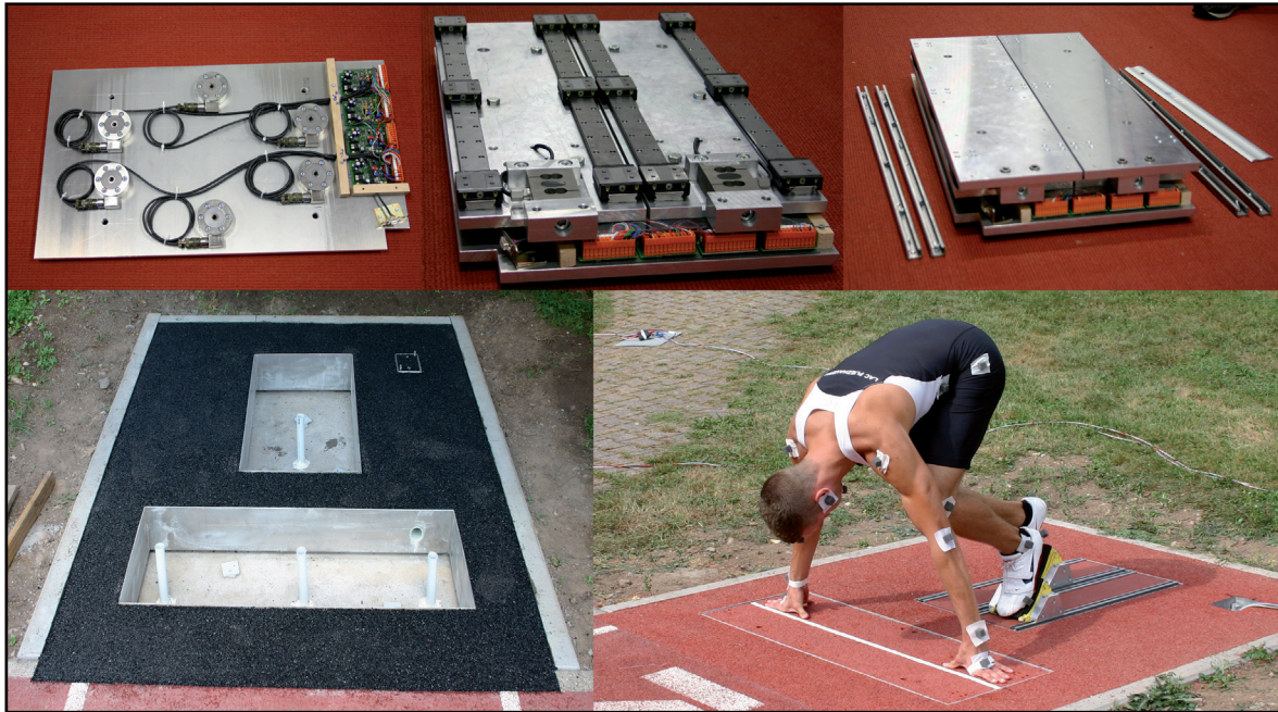
Abb.1. Messplatz zur Erfassung der Bodenreaktionskräfte beim Tiefstart: Sensorebenen der geteilten Zweikomponenten-Kraftmessplatte für die Beinkräfte (oben), Bodenfundament im Rohbau (links unten), in die Laufbahn integrierte Kraftmessplatten für Bein- und Handkräfte (rechts unten).
