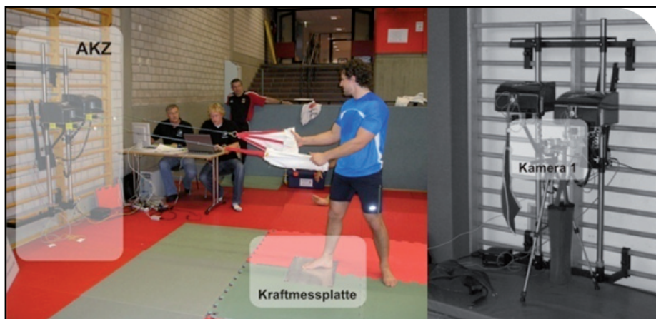
Abb. 1: Komplexer Messplatz AKZ (Kraftmessplatte, Videokamera 1 – frontal)
