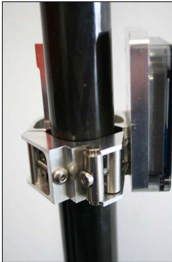
Abb. 4: Klemmschelle zur Montage am Paddel.
