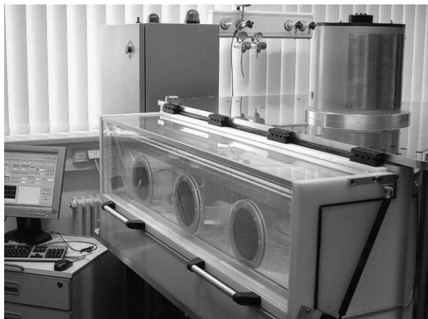
Abb. 2: Vorderansicht des Tieftemperatur-Tribometers,
