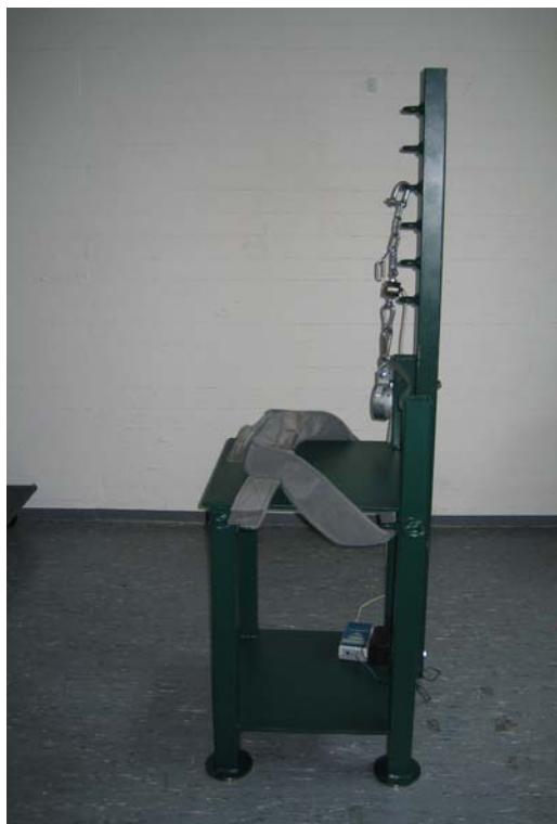
Abb. 1: Kraftmessstuhl (Ansicht von lateral)
