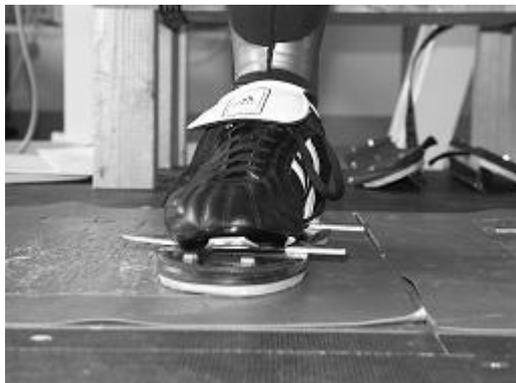
Abb. 1: Landung mit Wechselsohlensystem „Dummysohle“
