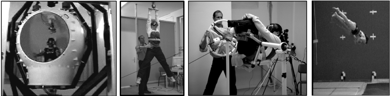
Abb. 1: Messplätze (von links): Vestibularisstimulationsgerät; Längsachsendrehgerät; Saltodrehgerät; okulographische Tests im freien Flug mit 3-D-Kinemetrie; Versuchsperson jeweils mit Videonystagmographiebrille
