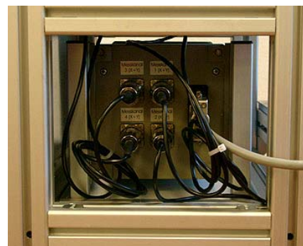
Abb. 2: Vorderseite (links) und Rückseite (rechts) der Verstärkerelektronik für die acht Kraftsensoren
