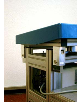
Abb. 1: Links: Mechanische Konstruktion des Mobilen Mess-Startblocks (vorne an der Trittstufe ist eine Vorrichtung für die Eichung der horizontalen Kräfte angebracht). Rechts: Detailaufnahme eines Kraftsensors zur Erfassung von vertikalen Kräften
