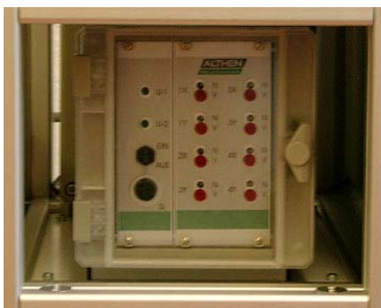
Abb. 2: Vorderseite (links) und Rückseite (rechts) der Verstärkerelektronik für die acht Kraftsensoren
