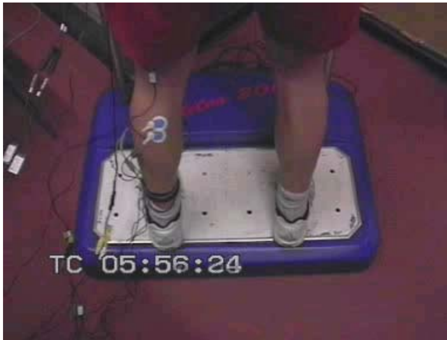
Abb. 1: Vibrationsbelastung mit EMG und Beschleunigungsgebern am Galileo 2000
