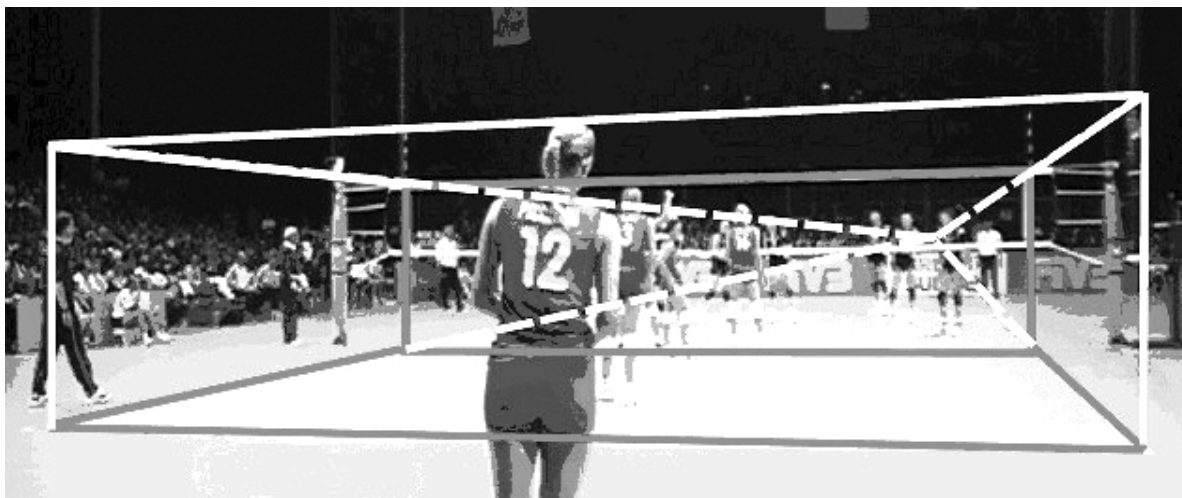
Abb. 1. Beispiel für die geometrische Konstruktion des Kalibriermodells. Die Raumkoordinaten der dunklen Linien (Spielfeldmarkierung, Netzkante) sind entsprechend dem offiziellen Regelwerk bekannt (FIVB, 2000). Die Koordinaten der hellen Linien sind mit Hilfe der gestrichelten konstruiert
