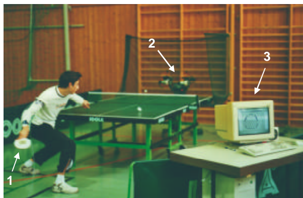
Abb. 3: Treffpunkt-Analyser-Messplatz Messschläger (1); Ballroboter mit Fangnetz (2); PC-Auswerteeinheit (3)
