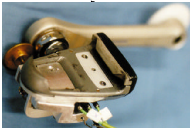
Abb. 1: 3D-Kraftmesspedal nach LOOK-Norm
