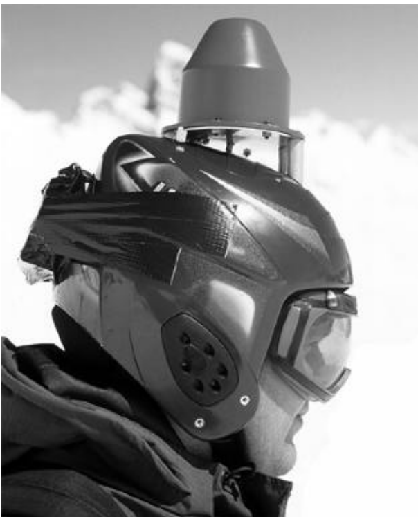
Abb. 1: Skihelm mit Zweifrequenzantenne
