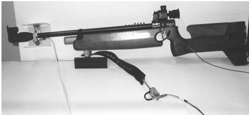
Abb. 4: Kraftsensor am Unterstützungsgurt/Kraftsensor am Abzugsbügel/Kraftsensor an der Schaftkappe/Beschleunigungssensoren an der Laufmündung
