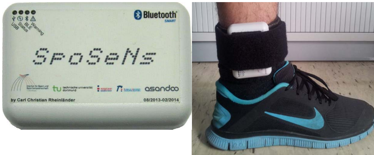
Abb. 1: Sensor-Knoten (links), Befestigung des Knotens am Knöchel des Sportlers (rechts)
