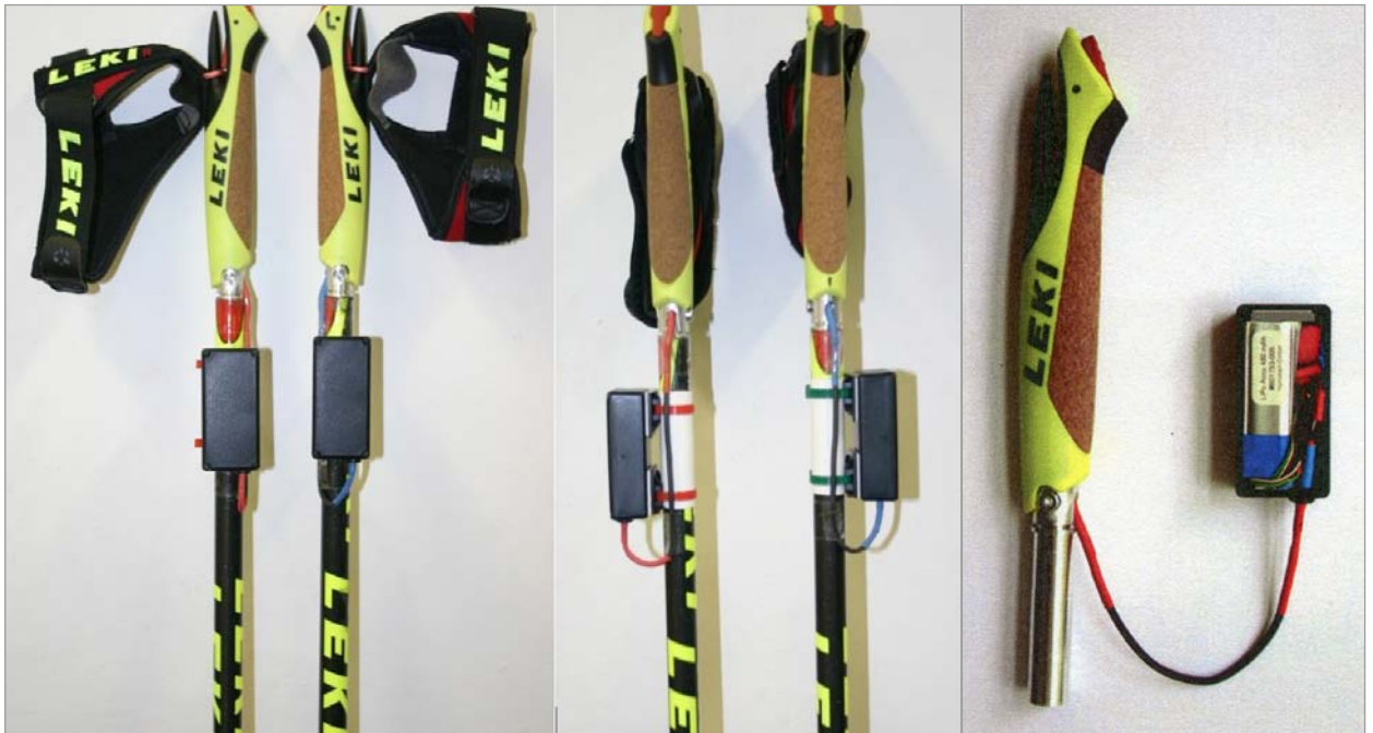
Abb.2: Sensorstöcke mit im Griff integrierten Axialkraftsensoren und einer Messbox mit IMU, Datenlogger und Stromversorgung.
