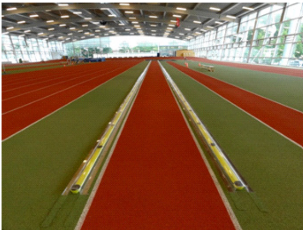
Abb. 1. OptojumpNext Messgerät mit einer Länge von 50 m
