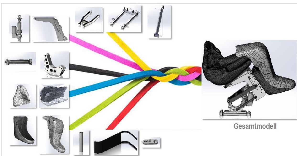
Abb. 4: Scan aller Bauteile, Erstellung der CAD Dateien und Zusammenführung der Baugruppe in das Gesamtmodell
