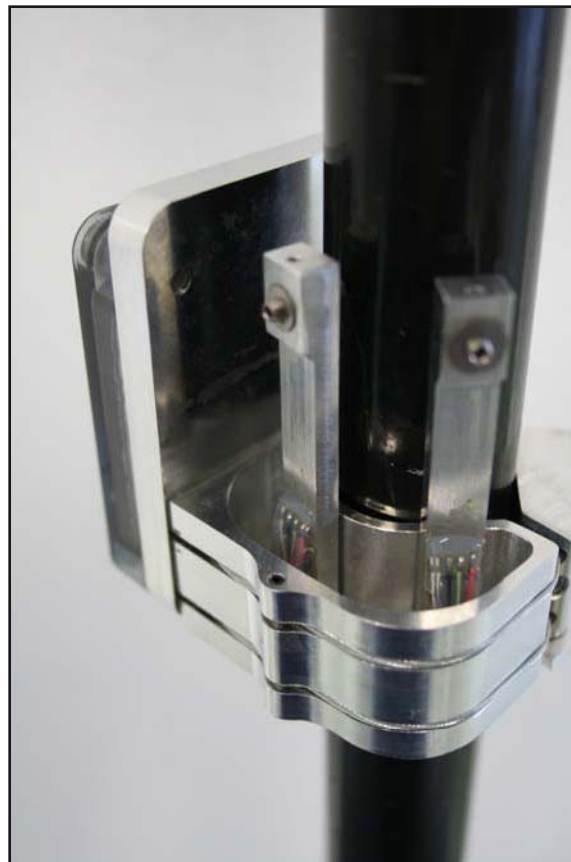
Abb. 1: Biegebalken erfassen die Biegung des Paddelschaftes.
