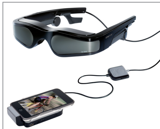
Abb. 1. Videobrille „Cinemizer“ mit angeschlossenem iPod® (Zeiss, 2011)
