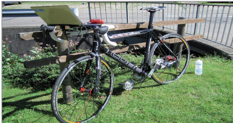
Abb.2. Das Messrad mit Netbook und Powerforce Messsystem.
